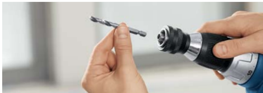
zasunutí středícího vrtáku....
