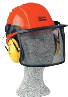
Ochranná přilba Profi Plus, atest KWF = FPA, kovový štít V4c se sluneční clonou, hustota ok 1,8 x 2,5 mm, nerezová ocelová síťka s propustností světla 75 %, s ochranou sluchu H510P3e, SNR 26 dB(A). 988.000.006
