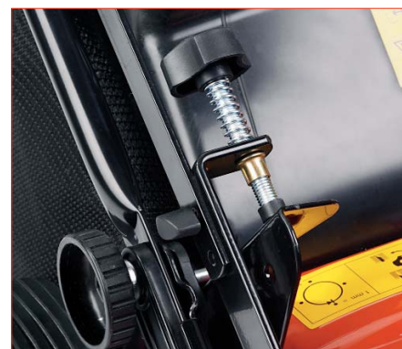
Ruční, na milimetr přesné nastavení pracovní hloubky.
