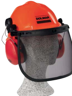
Ochranná přilba DOLMAR Safety pro příležitostné, soukromé použití, je-li zapotřebí úplného ochranného vybavení pro práci s motorovou pilou. Standardní, plastový štít, hustota ok 1 x 1 mm, ochrana sluchu standardní, SNR 23 dB(A). 988.000.005
