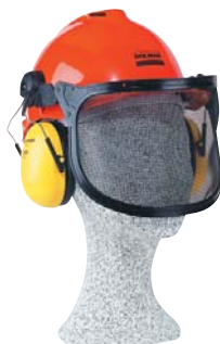
Ochranná přilba G22d, plastový štít V1b bez sluneční clony, s hustotou ok 1,0 x 1,0 mm, s matnou černou plastovou sítí, propustnost světla 55 %, ochrana sluchu H510P3e, SNR 26 dB(A). 988.000.011
