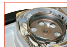
Brzdová páska pro zastavení nožů.
